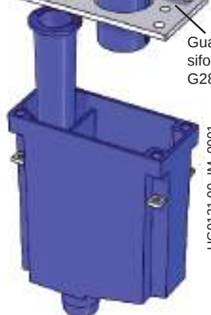
Sifone completo di elettrodo di rilevazione condensa C09385
