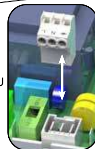
Connettore alimentazione su scheda CPU
